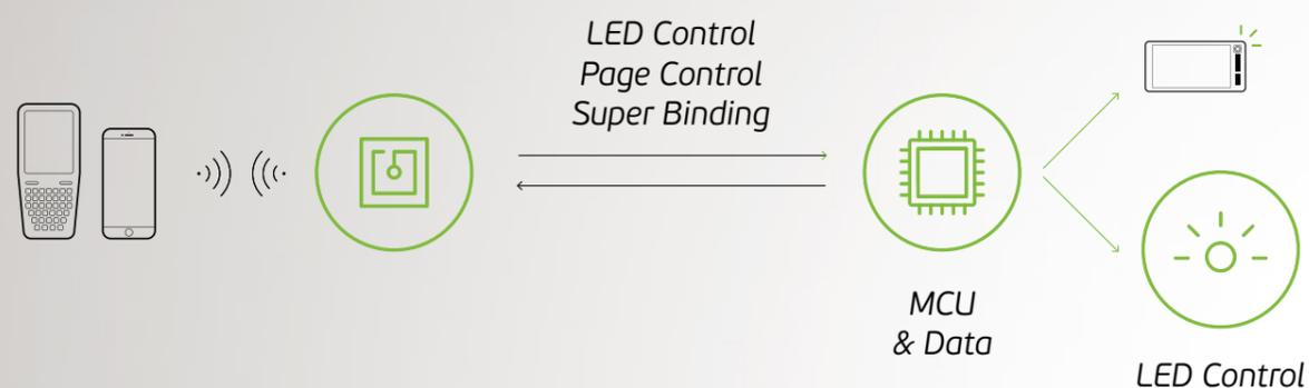
Il personale dotato di un PDA o dispositivo mobile può *interagire con le etichette elettroniche* per visualizzare le pagine operatore, sincronizzare i dati degli articoli e controllare l'accensione dei LED.
